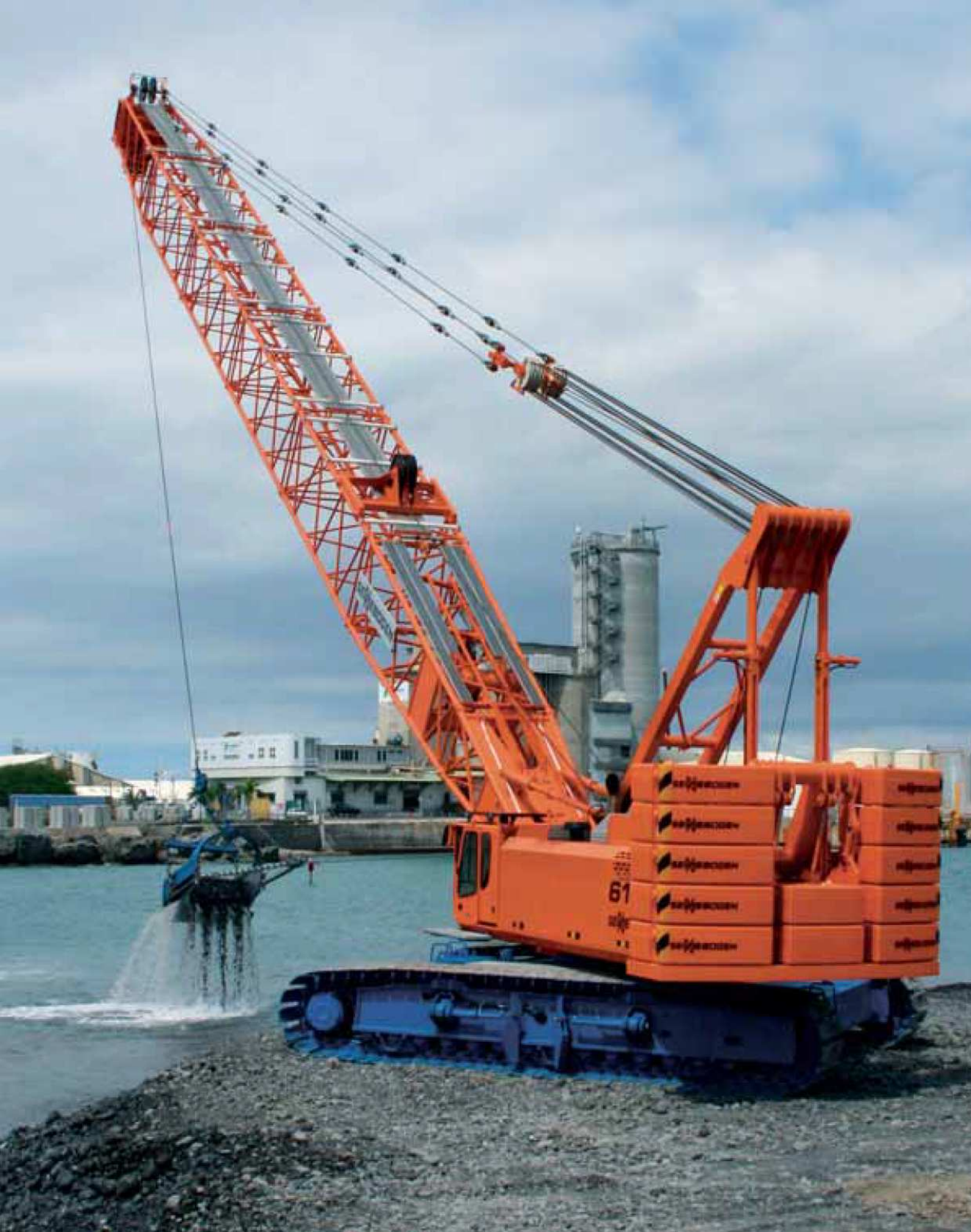
6180 HD - Dredging works in port with 3,9 cubic yards dragline bucket; La Reunion 6180 HD - Ausbaggern der Hafeneinfahrt mit 3 m 3 Schleppschaufel; La Reunion
