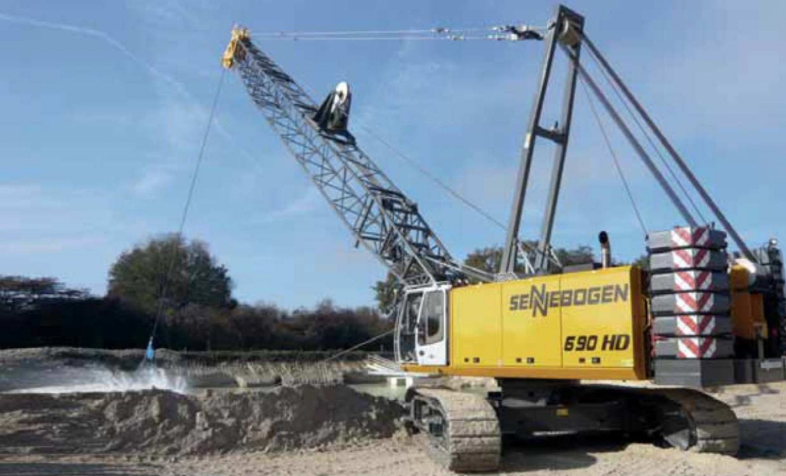
690 HD – Dragline operation with 4 cubic yards bucket; France 690 HD – Schleppschaufeleinsatz mit 3 m 3 Schaufel; Frankreich
