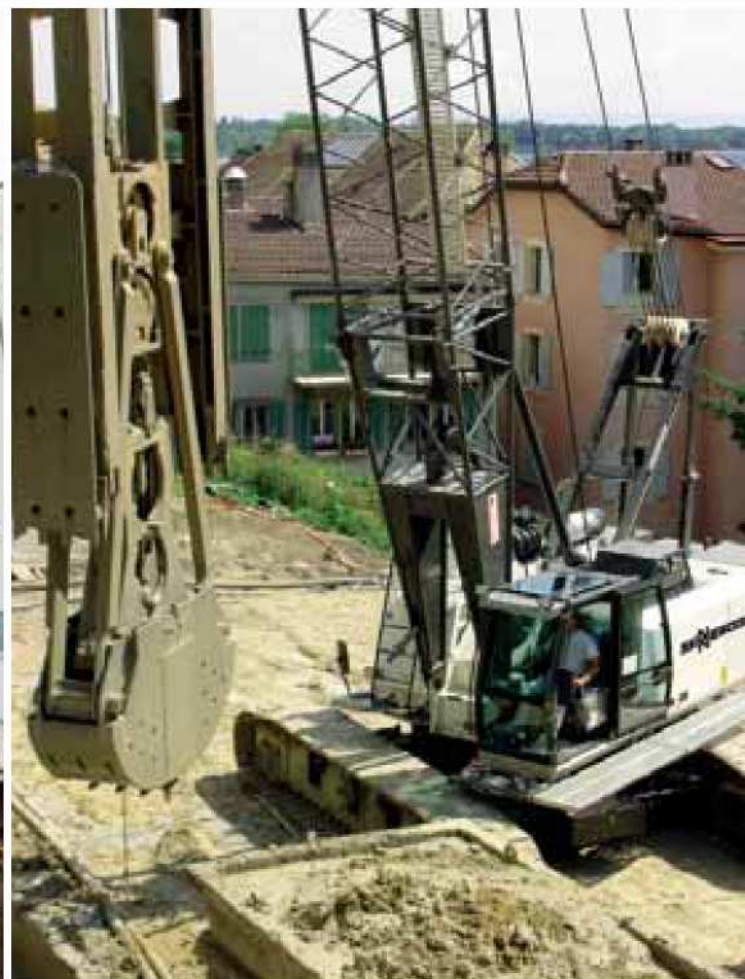
655 HD - With mechanical Stein-diaphragm wall grab; Belgium 655 HD - Mit mechanischem Stein-Schlitzwandgreifer; Belgien
