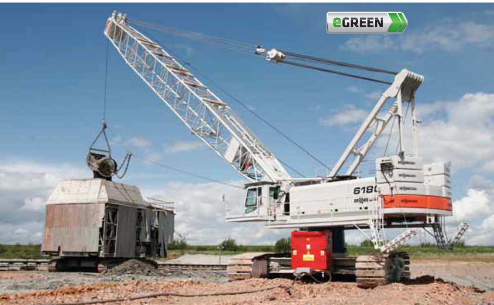
6180 HD - Dragline operation with electric motor with 7,8 cubic yards bucket; Great Britain 6180 HD - Schleppschaufeleinsatz mit Elektromotor mit 6m 3 Schaufel; Großbritannien
