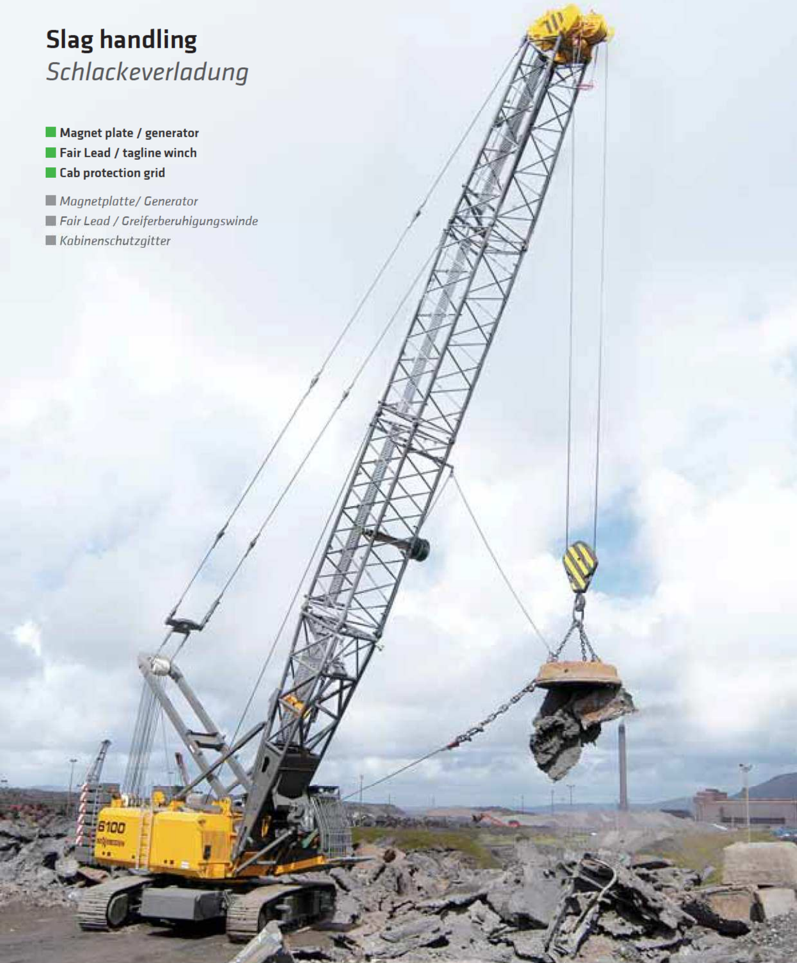
6130 HD - 24,3 m boom length - Slag handling with magnet plate; Great Britain 6130 HD - 24,3 m Auslegerlänge - Schlackeverladung mit Magnetplatte; Großbritannien
