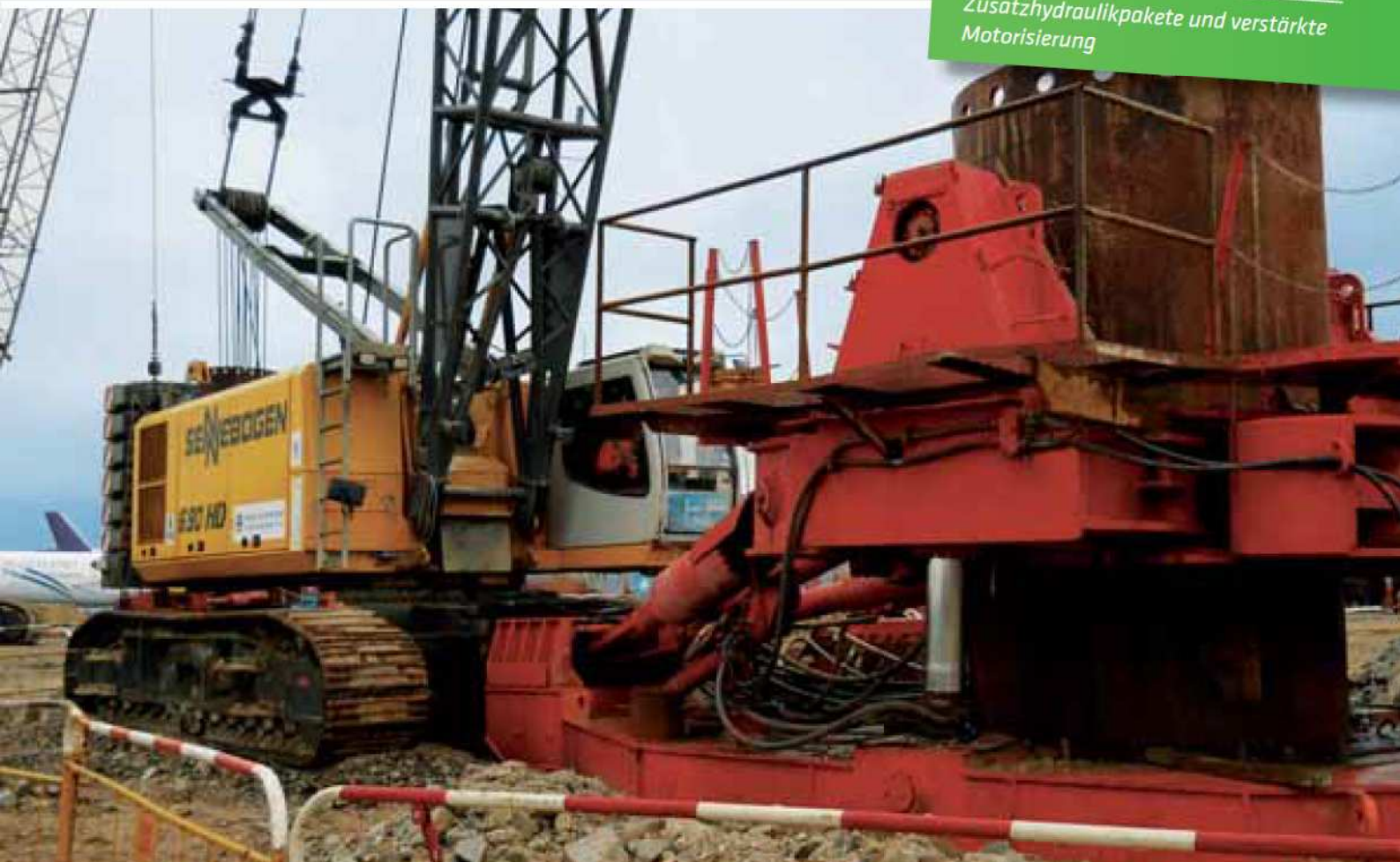
690 HD - With additional hydraulics for driving a casing oscillator; Hong Kong 690 HD - Mit Zusatzhydraulik für den Betrieb einer Verrohrungsmaschine; Hong Kong
