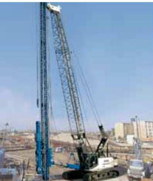
26 650 HD - With leader and piling hammer 650 HD - Mit Mäkler und Ramme
