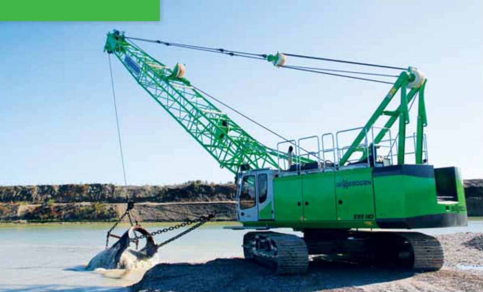
655 HD - Dragline operation with 3,5 cubic yards bucket; Germany 655 HD - Schleppschaufeleinsatz mit 2,7 m 3 Schaufel; Deutschland
