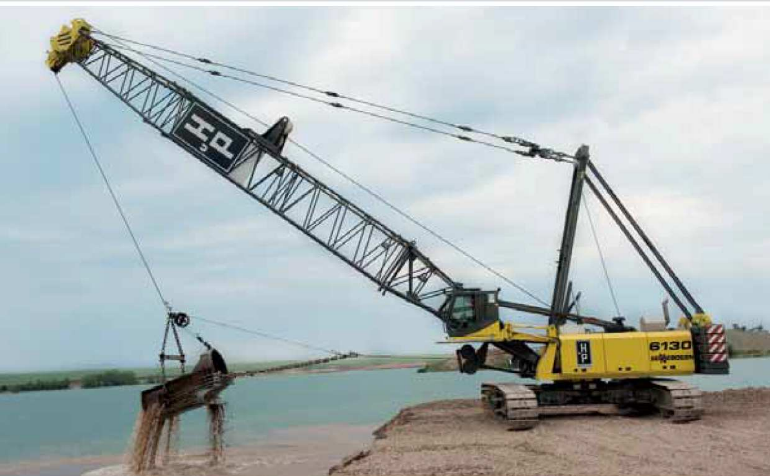
6130 HD – Sand and gravel quarrying with 5,6 cubic yards dragline bucket; Germany 6130 HD – Sand und Kiesförderung mit 4,3 m 3 Schleppschaufel; Deutschland
